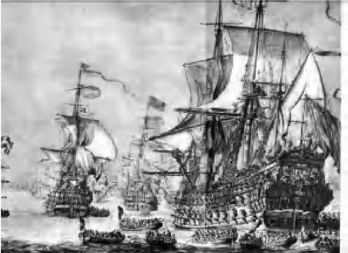
図 2 舷側に 4 層にわたり開いた多数の砲門。船尾にも後ろ向きの砲門がみえる。
