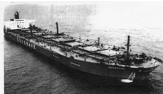
船主 Docenave 鉱油船 131,000 DWT 1977・11 竣工 同型 7隻の第6船 第7船は公試運転中主機関爆発 引渡後にもリオ湾内で爆発事故 イシプラスで改修工事(N143)
