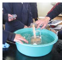
ペットボトル船の動揺実験
