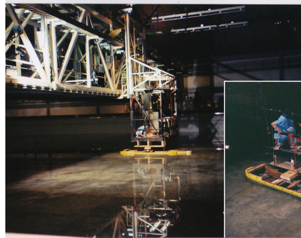
LHIでのプッシャーバージの水槽試験
