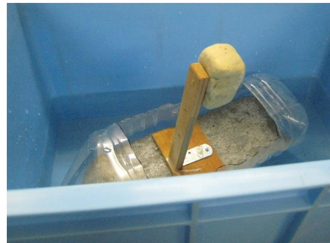
ペットボトル船の動揺実験
