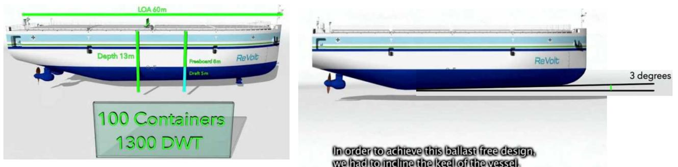
第 12 図 船体形状 Loa=60m, D=13m, d=5m, f=8m, Keel line 傾斜+3 度
