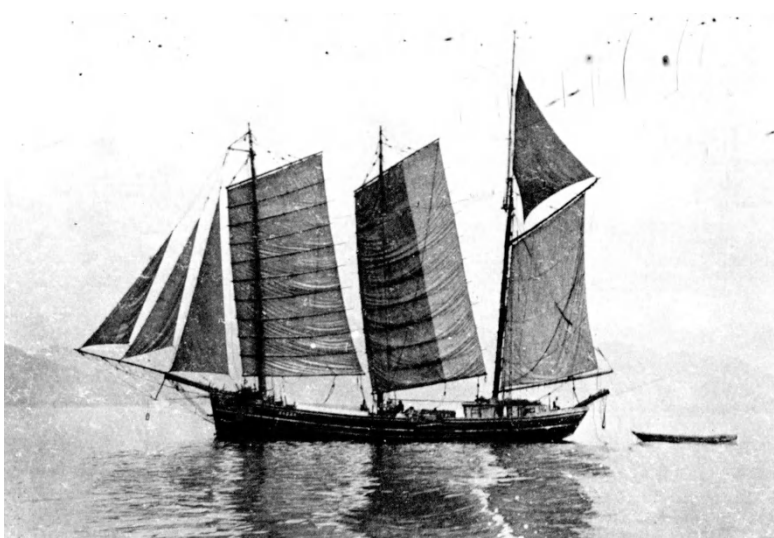
図 10 伸子帆を用いたスクナー（昭和初期） （図説和船史話より）
