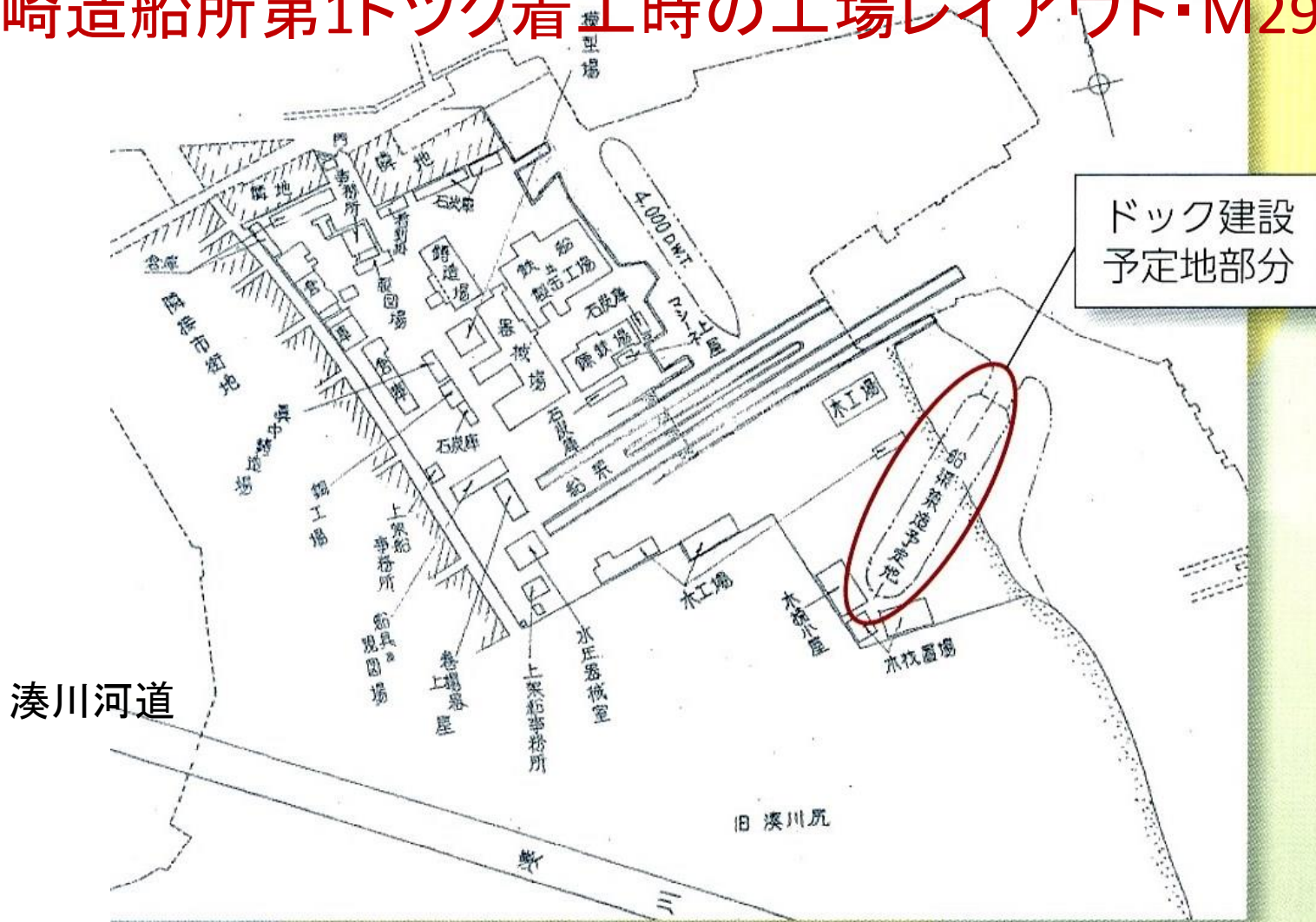
工事着工時（1896年）の工場レイアウト図 (点線部分は工事以降に埋立を行った海岸線)
