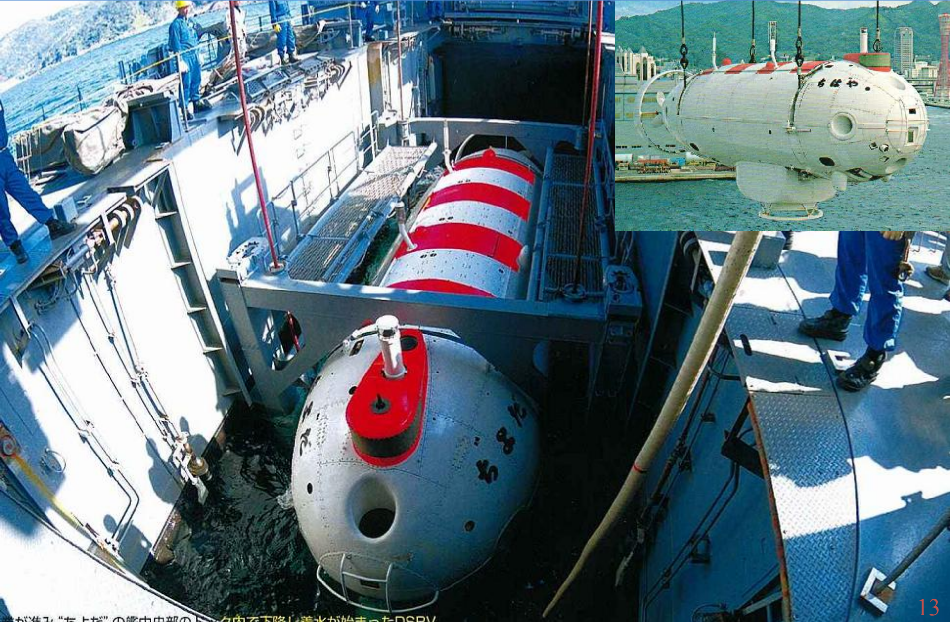
準備が済み「あよた」の艦中央部のトレーヤ内で下降し着水が始まったDSRV
