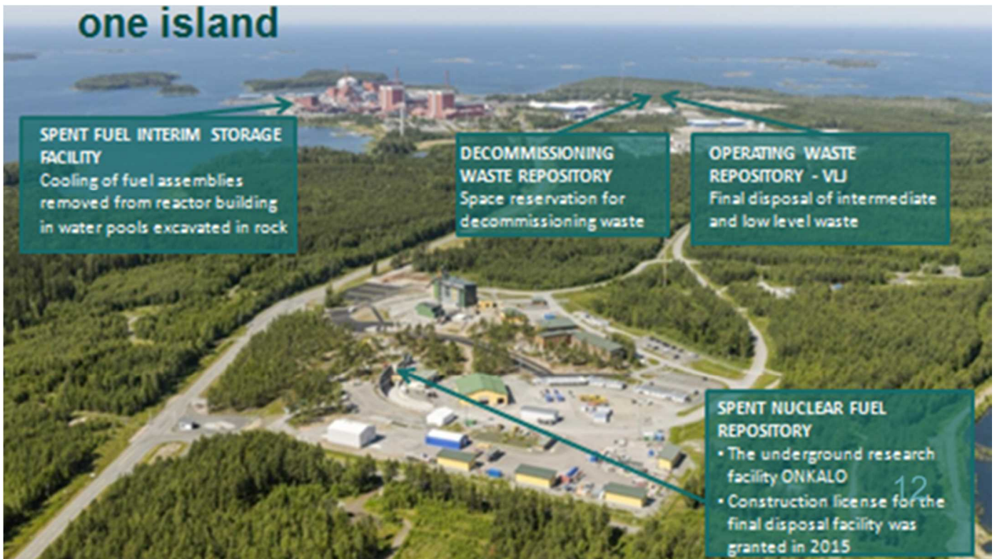
左上が使用済み核燃料の中間貯蔵プール。中央下が同廃棄洞窟・オンカロ入口。1つの島の中で処理。地産地消。 (Posiva 社資料より)
