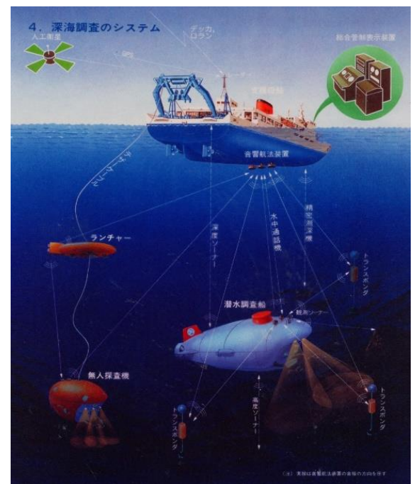
Fig. 2 6500m潜水調査船、無人探査機と支援母船間の深海調査オペレーション
